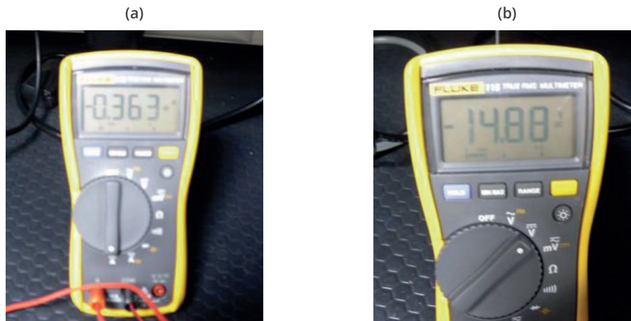
Fig. n°8: Valeurs mesurée sur la bobine : (a) Intensité ; (b) tension
